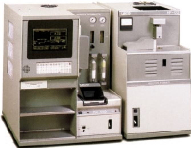
Abb.4: Wasserstoff-analysator nach dem Trägergasverfahren
